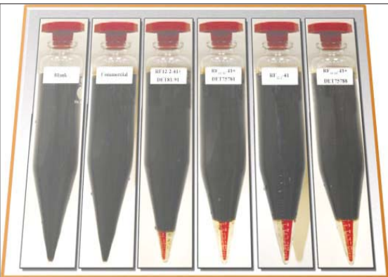
جداسازی آب و نمک به کمک دمولسیفایرهای ساخت پژوهشگاه صنعت نفت
