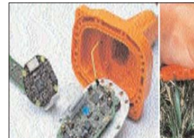
شکل ۱: نمونه ای از سنسورهای مورد استفاده در لرزه نگاری
